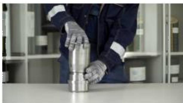
**10. Собранный фитинг необходимо надвинуть на трубу до упора. В технологическом отверстии гильзы должна быть видна напорная полимерная труба.**
