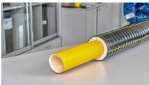
**7. При помощи трубореза выровнять торец напорной трубы, сделав срез на расстоянии 30 мм от торца.**
