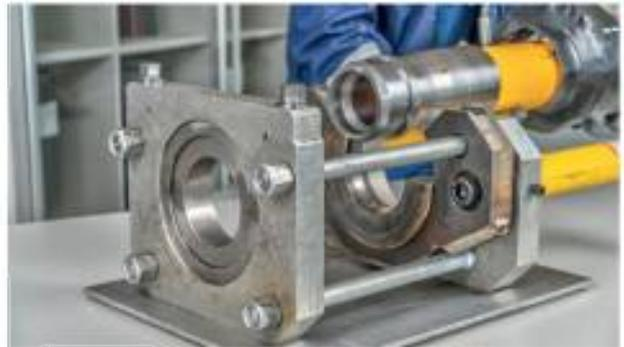
**13. Зафиксировать фитинг на упорной пластине надев вторую часть упорного полукольца. Зафиксировать полукольца прижимной планкой. На подвижную пластину добавить вторую половину протяжного полукольца и зафиксировать кольца прижимной планкой.**
