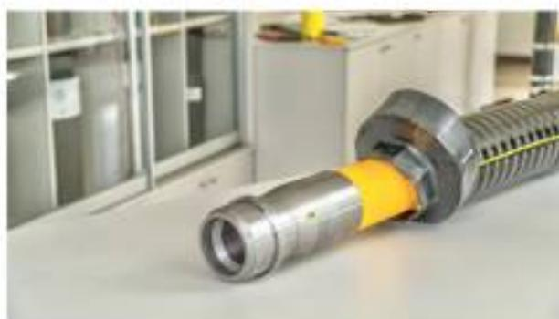
**11. Подготовить инструмент к монтажу, расположив на нижней части упорной пластины, упорное полукольцо соответствующего диаметра и компоновки. Расположить на нижней части подвижной пластины протяжное полукольцо соответствующего диаметра.**
